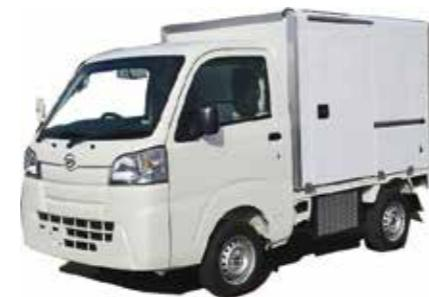
積載 350kg 設定温度 -7°C 普通免許 AT車
