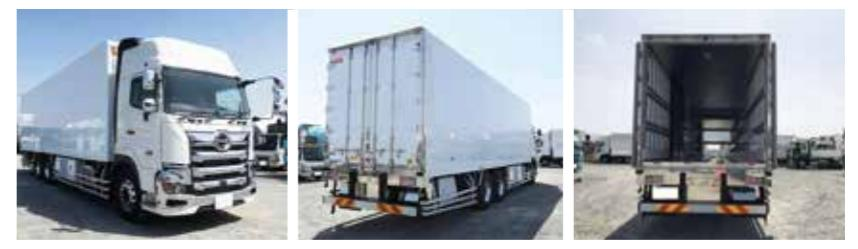
現在リース中の令和2年式日野プロフィア大型冷凍バンは、高床後2軸、左サイド観音扉、サーモキング製-29度設定、2層式、ジオルダー4列、スタンバイ付。
