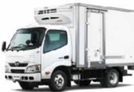
積載 2,000kg 設定温度-30℃ 準中型免許 MT車
