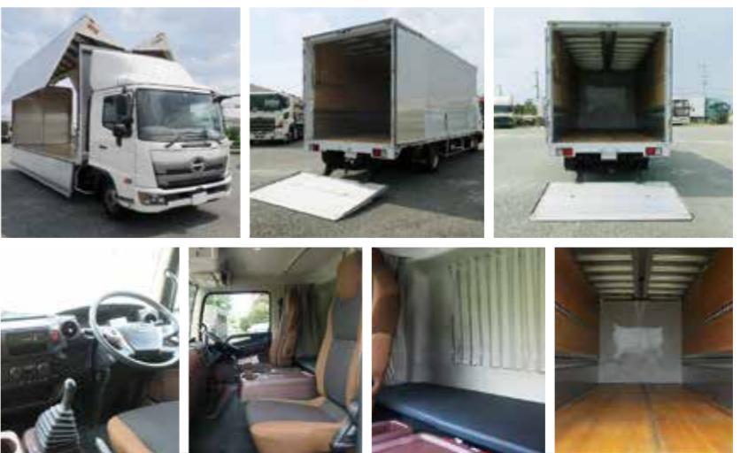
今回納車した令和1年式日野レンジャー中型アルミウイングは、6200ワイド、240馬力で格納PGや、ETC・バックアイカメラ搭載車。
