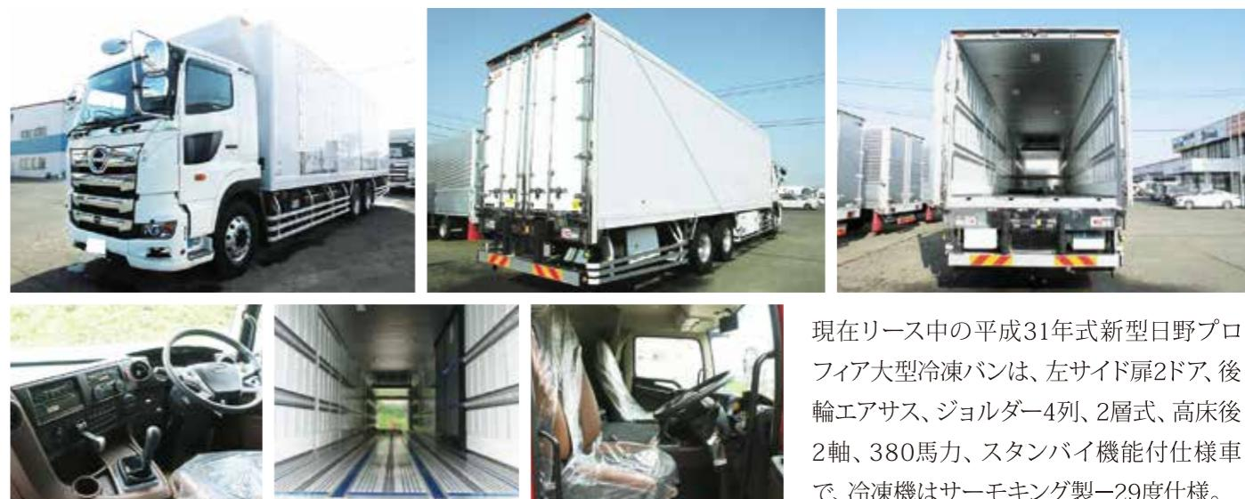
現在リース中の平成31年式新型日野プロフィア大型冷凍バンは、左サイド扉2ドア、後輪エアサス、ジョルダー4列、2層式、高床後2軸、380馬力、スタンバイ機能付仕様車で、冷凍機はサーモキング製-29度仕様。
