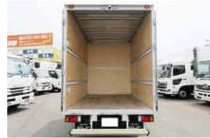
ラッピングレール2段付のため、複数の段ボルトなどをベルトで固定して運搬できる。
