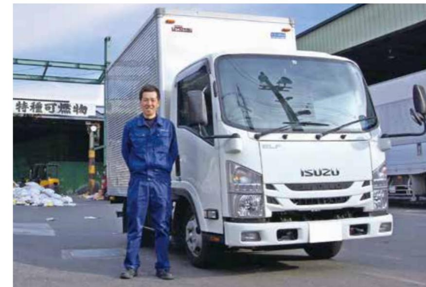
2t積載、全低床仕様車。準中型免許5t限定対応なので、旧普通免許で運転することができる。大量の書類などのほか、引越しや園芸品の運搬などにご利用されることが多い車両だ。
